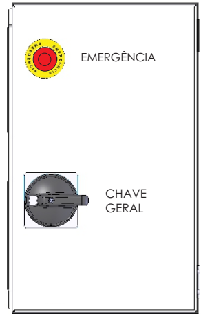
TAMPA QUADRO ELÉTRICO
