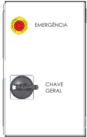
TAMPA QUADRO ELÉTRICO
