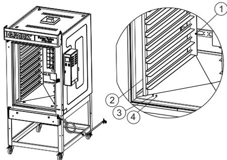
Para ajusta o porta esteira e necessário solta o parafuso (item 1) , após solto retirar o porta esteira (item 2), para retirar o porta esteira puxe o mesmo para cima até soltar a parte de baixo, após solto incline em 45° para soltar a parte de cima após isso posicione no pino lateral desejado (item 3, ou item 4), após posicionado encaixe e aperte o parafuso (item1).
